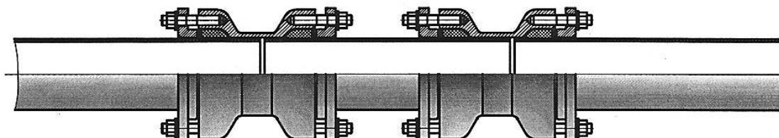
Рисунок 7.7 Ремонт трубопровода при помощи двойного растрuba компенсационного ДРК.
