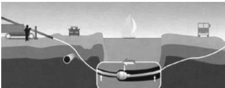
Рисунок 6.19      Расширение скважины.
