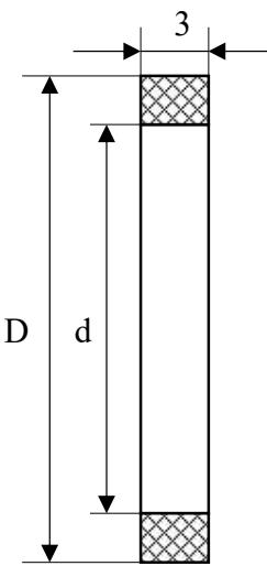
Рисунок 2.15 Уплотнительное кольцо для фланцевого соединения.
