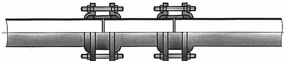
Рисунок 7.10 Ремонт трубопровода при помощи муфты ремонтной надвижной МРН.
