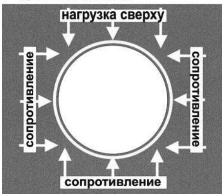
Механические характеристики заложенной в грунт трубы могут быть оценены через рассмотрение системы взаимодействия «труба/грунт»: взаимодействие труб с окружающим грунтом зависит от их жесткости или гибкости, которые, в свою очередь, характеризуют возникающие напряжения при различных условиях захоронения.
