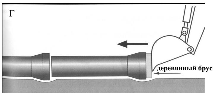
г) при помощи экскаватора и деревянного бруса
