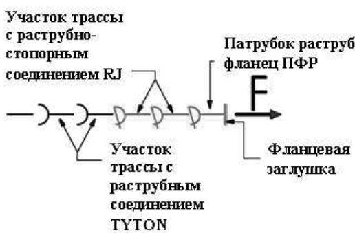
Этот метод состоит в фиксации (укреплении) необходимого количества соединений с каждой стороны отвода в целях использования сил трения между трубой и грунтом для компенсации сил гидравлического осевого давления
