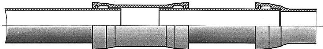
Рисунок 7.9 Ремонт трубопровода при помощи надвижной муфты МН.
