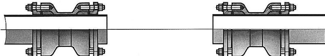
Отрезать необходимой длины новую трубу и установить её соосно с ремонтируемой трубой.
