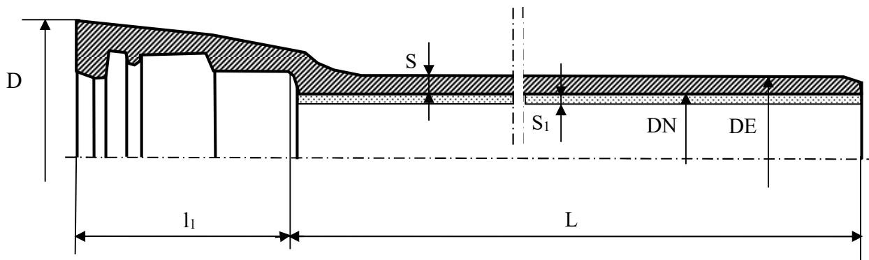
Рисунок 2.2 Труба раstrубная с соединением «TYTON».
