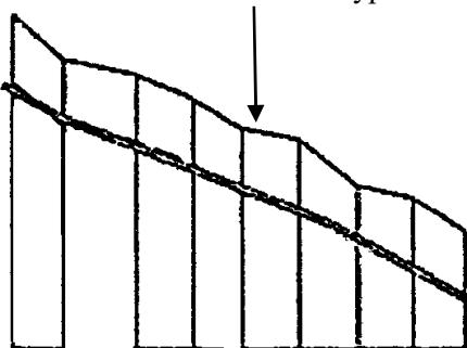
Рисунок 5.5 Трубопровод с постоянным уклоном.
