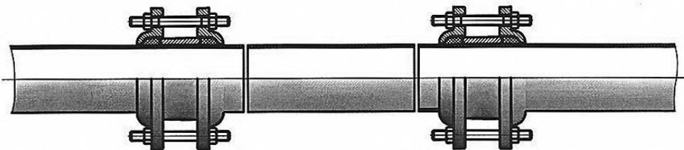
Переместить МРН так, чтобы стыки труб были посередине (между резиновыми уплотнителями) и затянуть гайки на шпильках.
