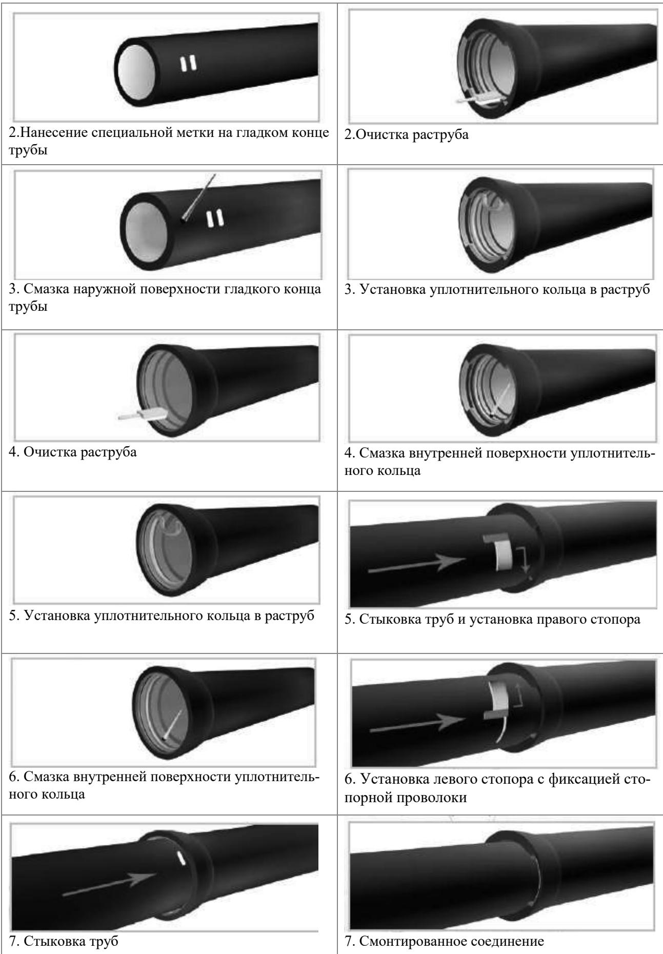
Рисунок 6.5 Монтаж труб с соединением TYTON и RJ.
