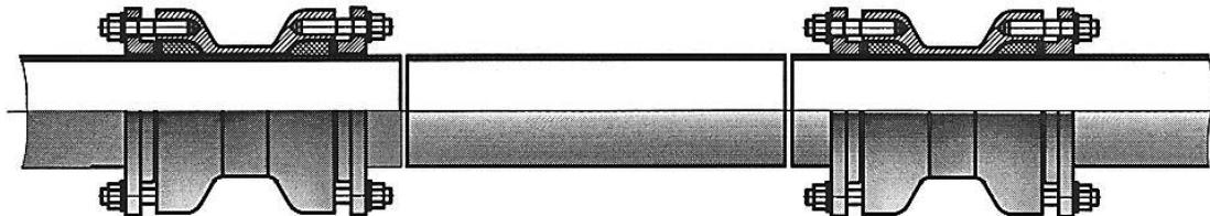
Переместить ДРК так, чтобы стыки труб были посередине (между резиновыми уплотнителями) и затянуть гайки на шпильках.
