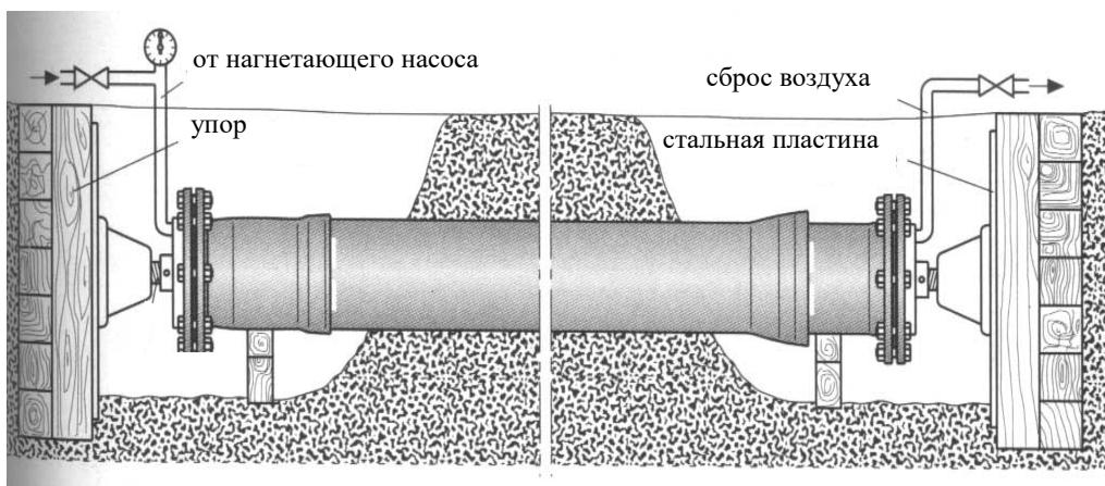
Рисунок 6.34 Гидравлические испытания трубопровода.
