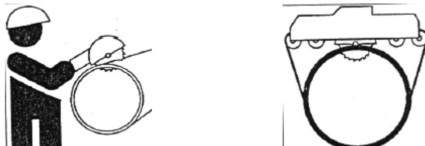
Рисунок 7.2 Резка трубы.
