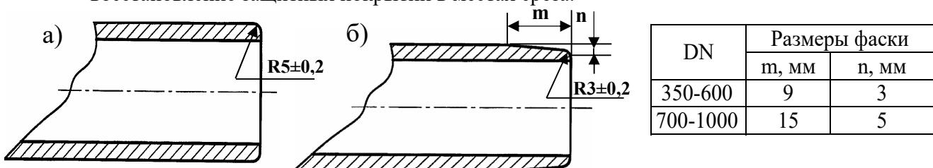
Рисунок 7.3 Торец гладкого конца трубы.
