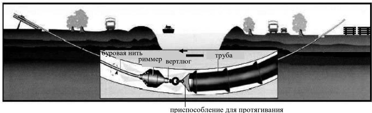
Рисунок 6.20      Протягивание трубопровода.
