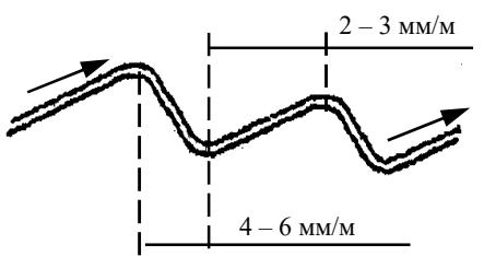
Рисунок 5.6 Трубопровод с переменным уклоном.
