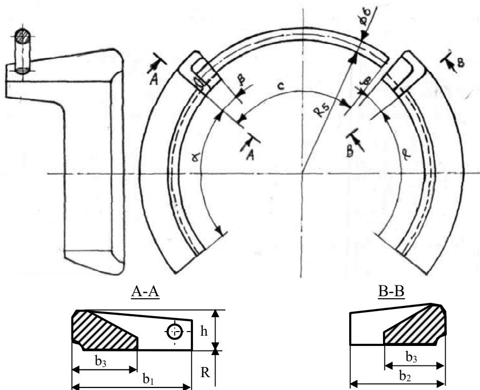
Рисунок 2.8 Стопор из ВЧШГ для соединения «RJ».
