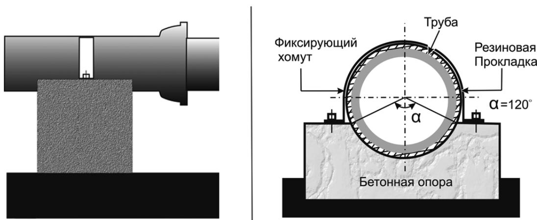
Рисунок 6.14 Крепление трубопровода к опорам.
