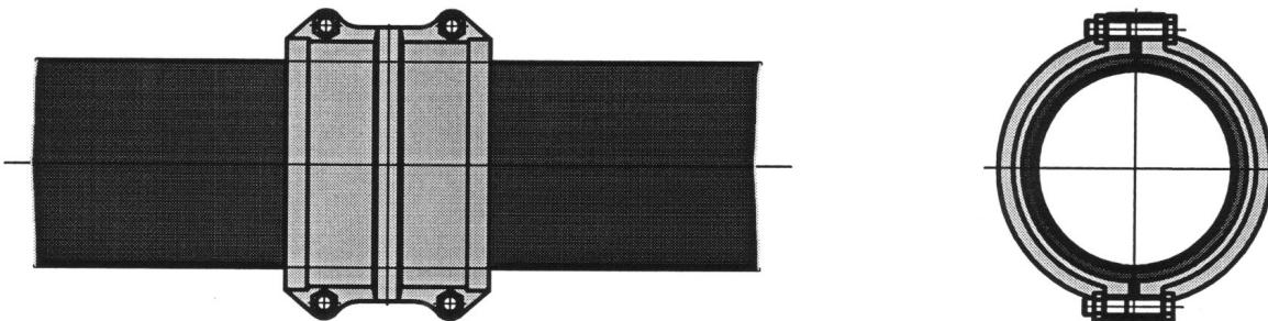
Рисунок 7.8 Ремонт трубопровода при помощи муфты свёртной МС.
